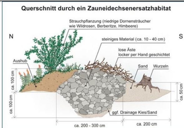
Abbildung 18: Prinzipskizze eines Ersatzhabitats mit Überwinterungsmöglichkeit (LfU, 2020b)
